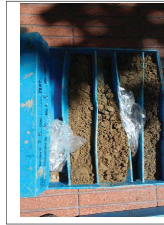
Foto 2: Sondieg S-1 de 3.0m-6.0m.
