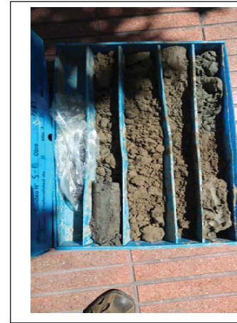
Foto 5: Sondieg S-1 de 12.0m-15.0m.
