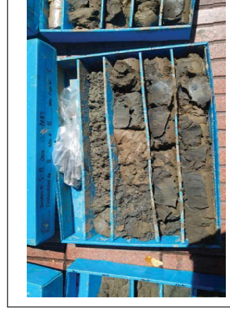
Foto 49: Sondieg S-10 de 12.0-15.0m
