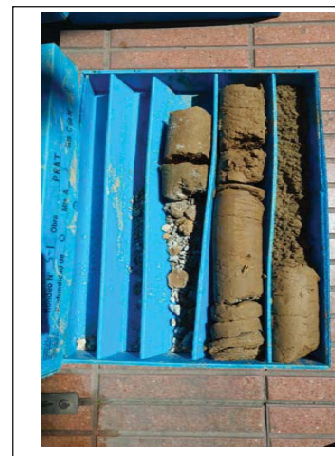
Foto 1: Sondieg S-1 de 0.0m-3.0m.
