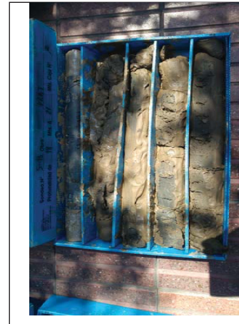
Foto 43: Sondieg S-13 de 18.0-21.0m
