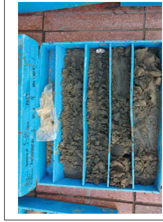
Foto 40: Sondieg S-10 de 6.0-9.0m
