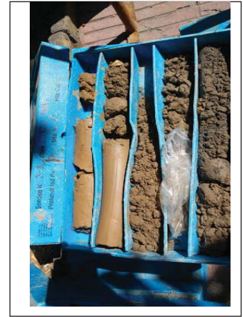
Foto 12: Sondieg S-3 de 3.0-6.0m.
