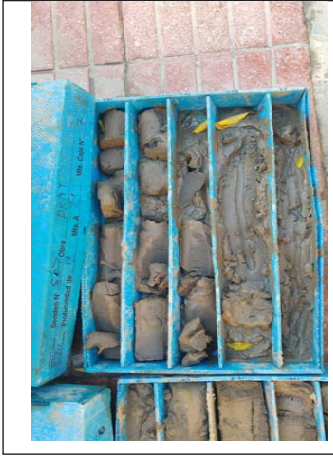
Foto 35: Sondieg S-7 de 18.0-21.0m
