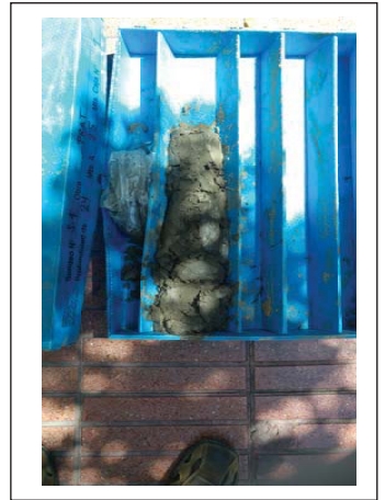
Foto 9: Sondieg S-1 de 24.0m-25.0m.
