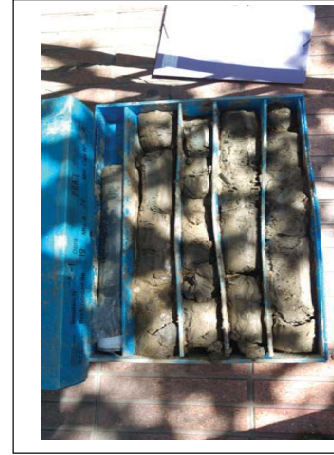
Foto 7: Sondieg S-1 de 18.0m-21.0m.
