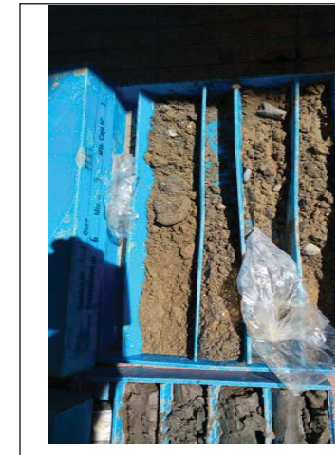
Foto 3: Sondieg S-1 de 6.0m-9.0m.
