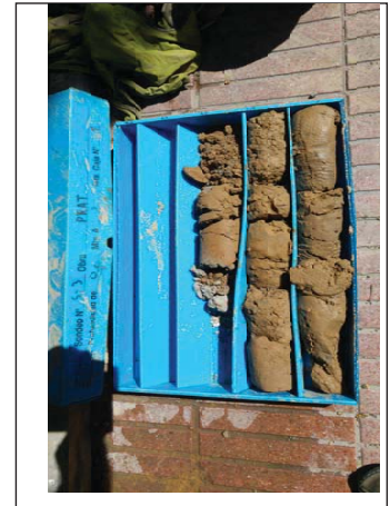
Foto 11: Sondieg S-3 de 0.0m-3.0m.
