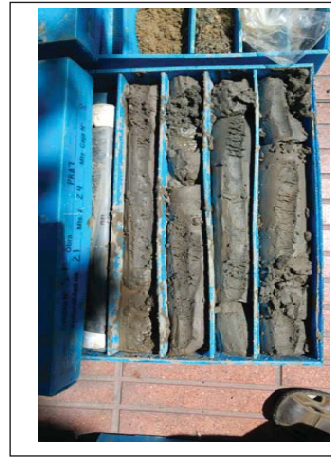
Foto 8: Sondieg S-1 de 21.0m-24.0m.
