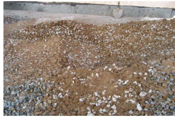
S'aprecia la homogeneïtat de la barreja
