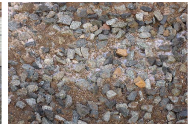
Materials després de l'aportació inicial d'aigua abans de la mescla.
