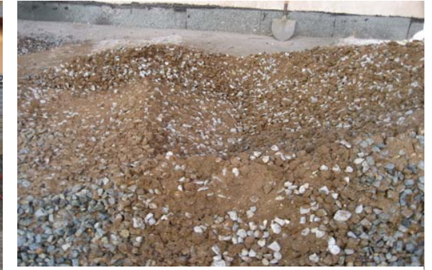
S'aprecia la homogeneïtat de la barreja
