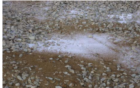
Detall de les partícules de l'hidrogel
